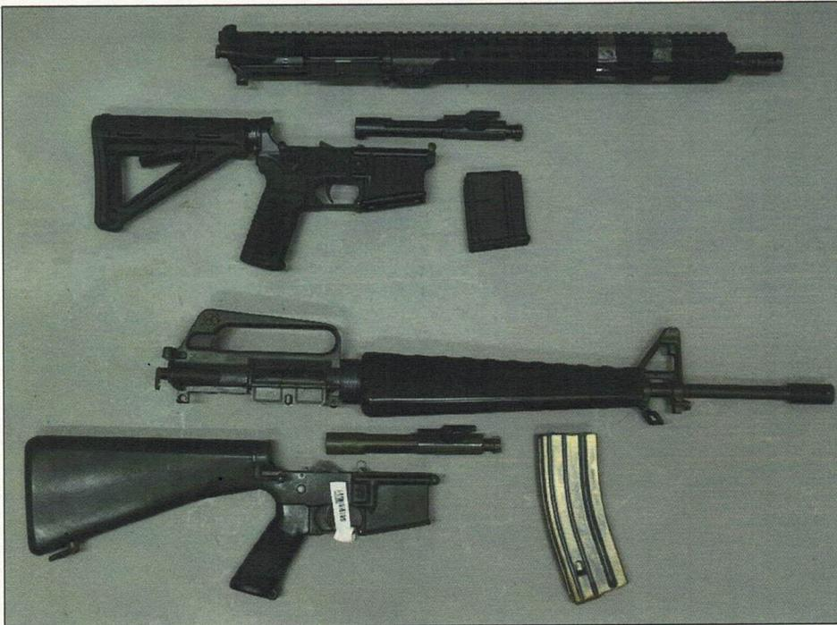
Abbildung 3: Vergleichsansicht rechte Seite, oben die halbautomatische „FAR 15“, unten die vollautomatische „M16“, beide zerlegt in die jeweiligen Hauptgruppen
