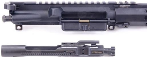
Nach erfolgter Entnahme des Verschlusses ist der Durchladehebel bis zur Aussparung zurückzuziehen und kann in gleicher Weise wie oben beschrieben aus dem oberen Gehäuse entfernt werden.
