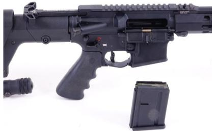
c. Ziehen Sie den Durchladehebel (3) nach hinten und schauen Sie auf der rechten Seite der Waffe durch das Auswurffenster in das Patronenlager und überzeugen sich davon, dass sich keine Patrone mehr darin befindet. Wenn Sie nach dem Zurückziehen den beidseitigen Verschlussfanghebel betätigen, rastet der Verschluss in der hinteren Stellung ein und Sie können durch Erasten mit dem Finger prüfen, ob das Patronenlager frei ist.
