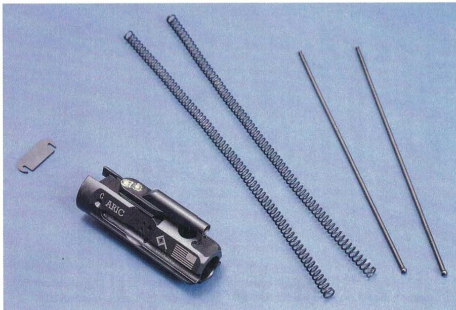
Der ARIC-Verschluss mit demontierten Schließfeder-Führungsstangen.
